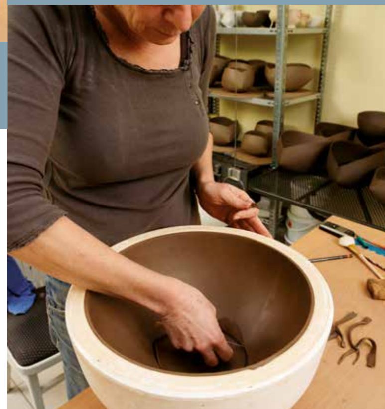
Applico una certa pressione per congiungere perfettamente le lastre prima di rifinire e lisciare le superfici Compress the slabs together gently before refining, and smoothing process
