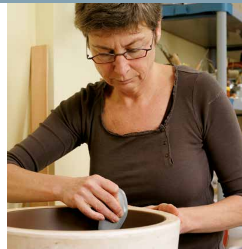
Per finire alla perfezione la superficie interna, metto la forma di gesso sul tornio e rifinisco tutto con una spatola di gomma To finish the inside properly, I place the plaster mold on the throwing wheel and smooth it all with a rubber kidney
