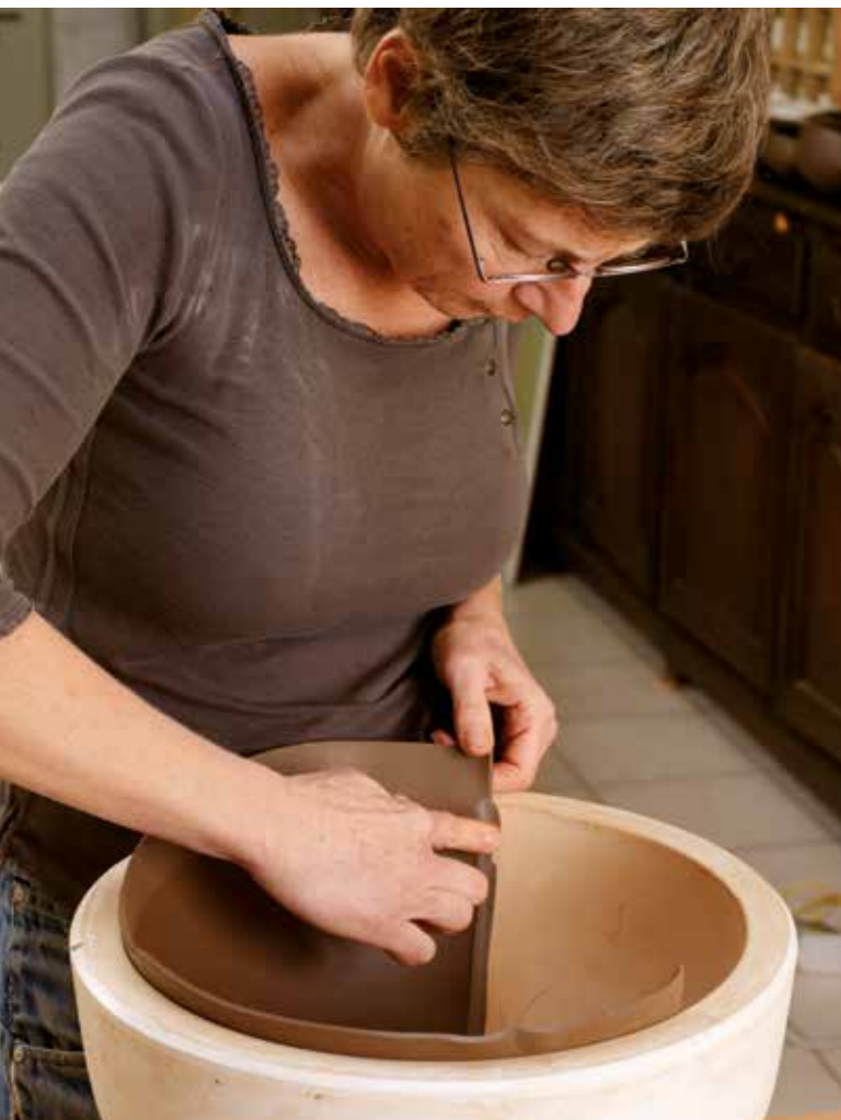
Creo delle dime per tagliare le lastre nelle forme desiderate I make templates to cut the slabs into the right form
