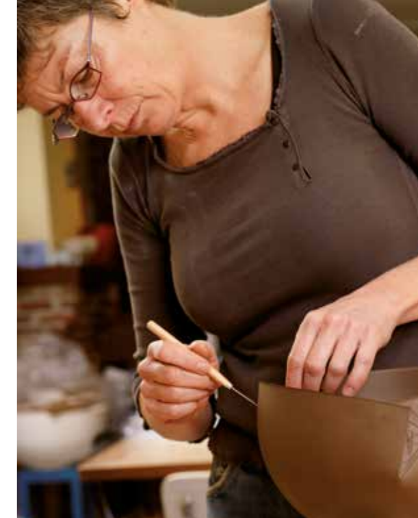
Incido le superfici che saranno congiunte I scratch on the parts that will be joined
