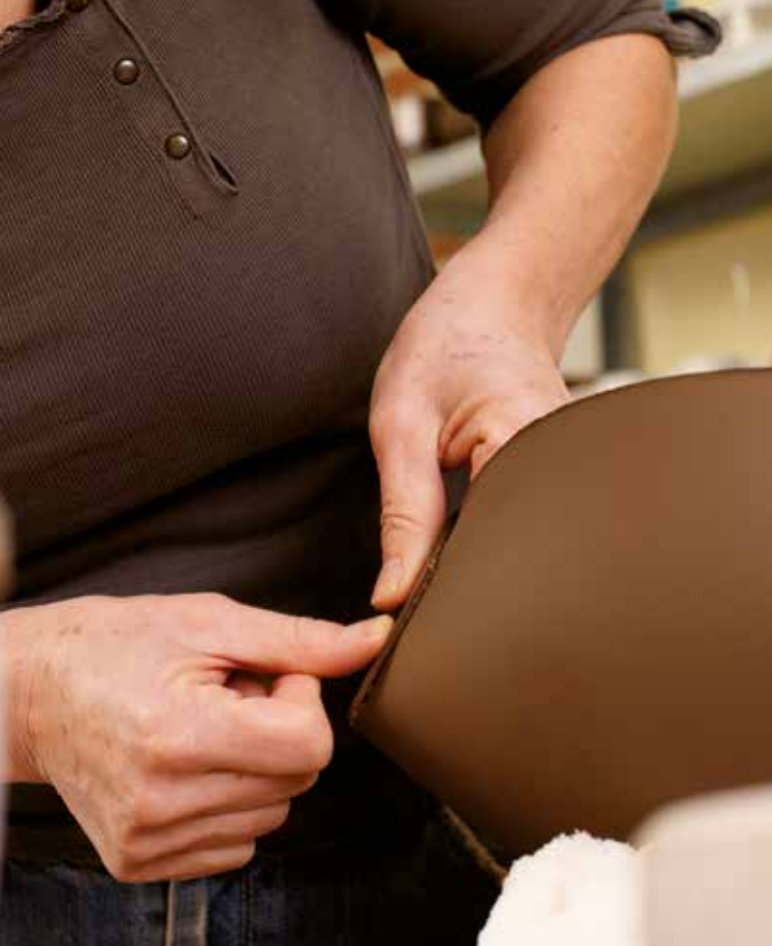
Applicazione di una leggera pressione per unire le lastre Compress the slabs together gently
